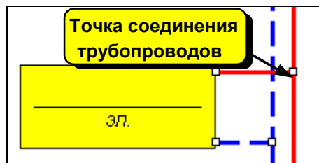
Рис. 5.18. Пример правильного соединения трубопроводов
